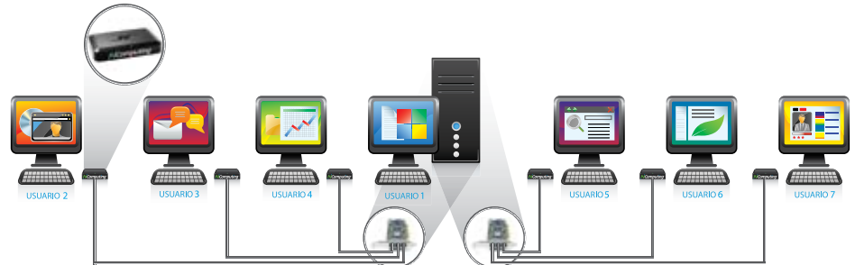
Configuración de la serie X: conexión directa
