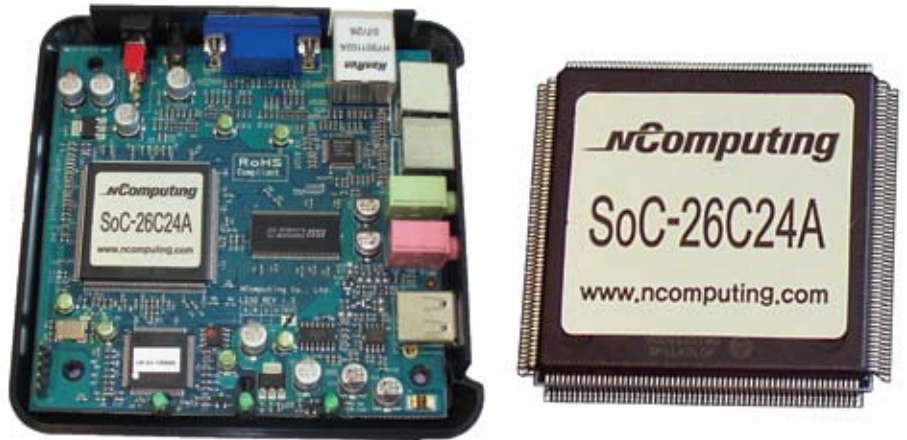
El sistema integrado (System-on-Chip, SoC) de NComputing se encuentra en el centro de cada dispositivo de acceso.
